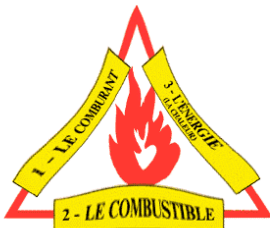
Figure 29 : Eléments nécessaires pour le déclenchement d'un incendie
