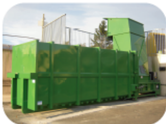
Tête de compaction et caisson du compacteur
